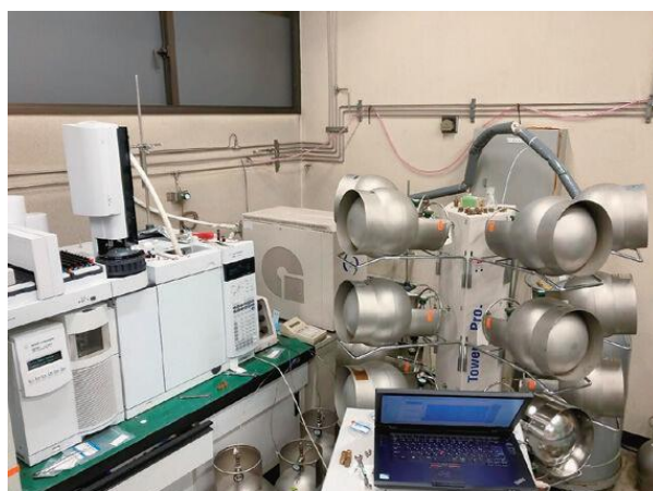
写真 2. ガスクロマトグラフィー質量分析計 (左) と濃縮導入装置 (右) (名古屋市環境科学調査センターだより Vol. 43 より引用)
