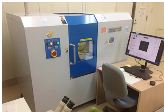
図 5. 微小な貝殻を精密に分析可能なマイクロフォーカス X 線 CT
