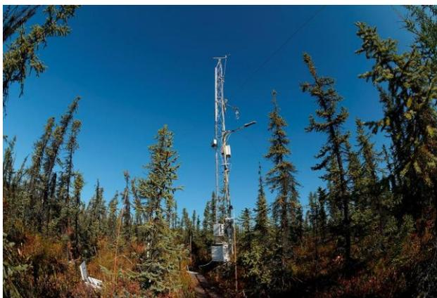
図1. 米国アラスカ州フェアバンクス永久凍土上のクロトウヒ林に設置された、森林のCO<sub>2</sub>吸収を評価するための気象観測タワー。30分毎に、365日、20年以上、森林のCO<sub>2</sub>吸収量を連続的にモニタリングしている。
