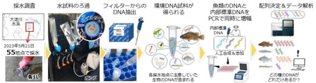
図2. 環境DNA定量メタバーコーディング法による定量的な魚類相調査の流れ
