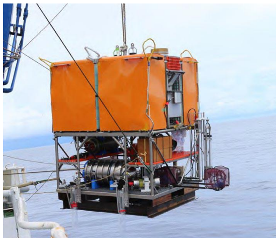
（写真1）大深度海底設置型観測システム「FFC11K」
