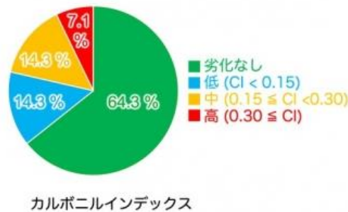
図5: カルボニルインデックスとヒドロキシルインデックスによるポリプロピレン劣化度評価
