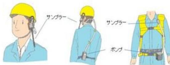
図 個人サンプリング法の試料採取機器
