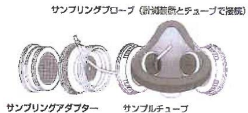
図左：マスクフィットテスト実施状況、図右：サンプリングアダプター取付け例 (中災防マスクフィットテスト実施者養成研修資料から引用)
