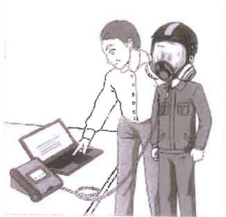
図左：マスクフィットテスト実施状況、図右：サンプリングアダプター取付け例 (中災防マスクフィットテスト実施者養成研修資料から引用)
