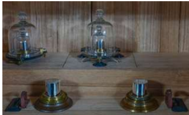
図1 キログラム原器（上段中央）、キログラム副原器（上段左）と貫原器（下段左および右）
