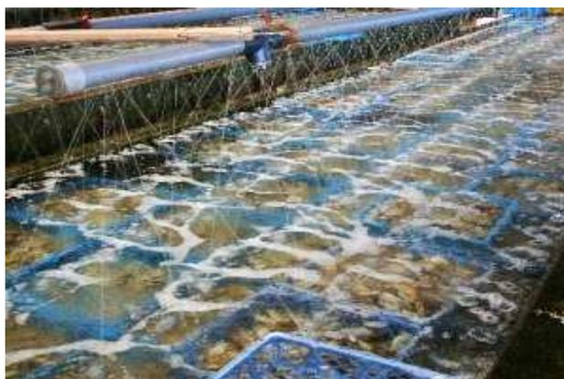
紫外線照射による流水式海水浄化装置
