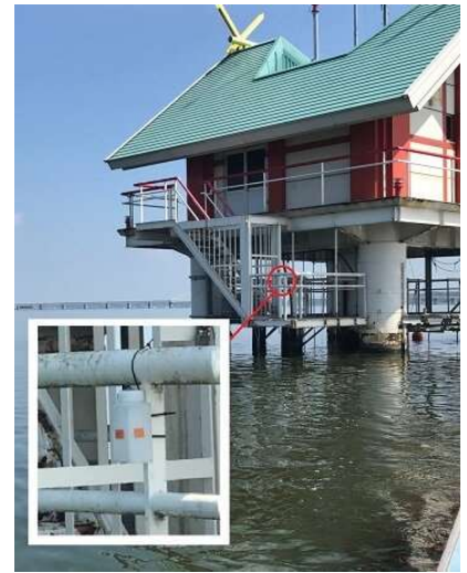
図2 北浦湖心に設置した拡散型パッシブサンプラー
