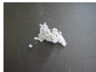
石綿含有吹き付け材
