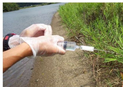
写真：採水した河川水をろ過している様子。シリンジの先のフィルターにDNAを捕集。
