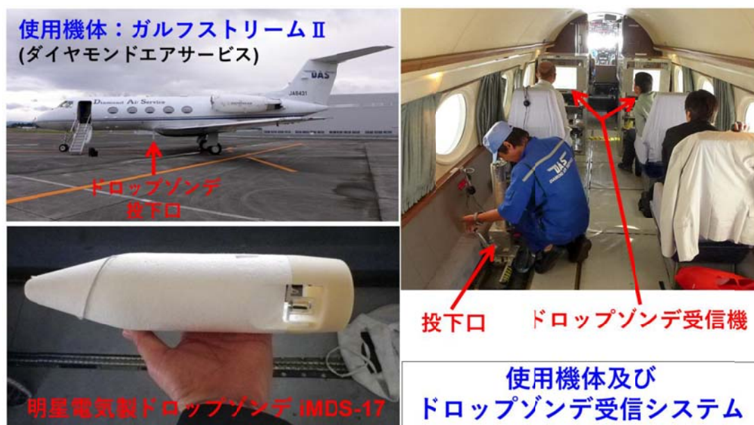
図1 (左上) 航空機観測に使用したダイヤモンドエアサービス株式会社のガルフストリームII。(左下) 本研究で航空機から投下したドロップゾンデと呼ばれる観測機器。観測したデータを電波で航空機に送る。(右上) 観測を行った際の機内の様子。
